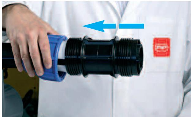
**NOTA:** Nel caso si utilizzino per la riparazione un giunto a scorrimento ZRP ed un bigiunto con battuta ZBP è sempre necessario installare preliminarmente il giunto con battuta.
