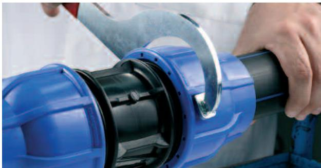
Per il serraggio delle ghiere, oltre alle apposite chiavi di serraggio MagnumGRIP è consentito utilizzare chiavi a catena od a nastro.
